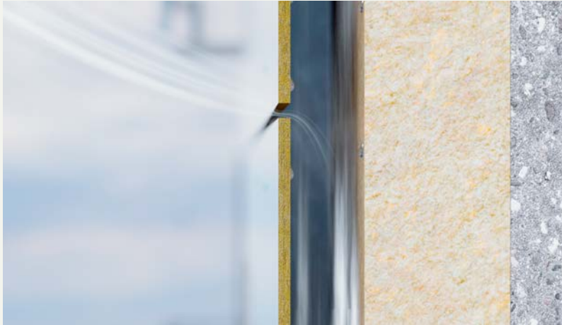
Ventilasjonseffekten bak og gjennom fugen i fasadekledningen
