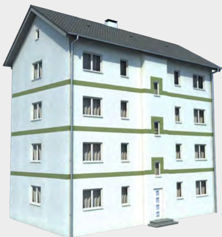
Behinderung der Brandausbreitung durch Brandriegel .
