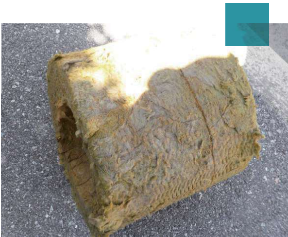
120°C から 140°C で 3 年間使用後の ROCKWOOL WR-Tech の断熱材
