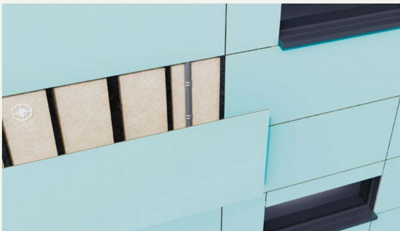
Konstrukcja fasady wentylowanej może być indywidualnie demontowana, co umożliwia ponowne użycie lub recykling
