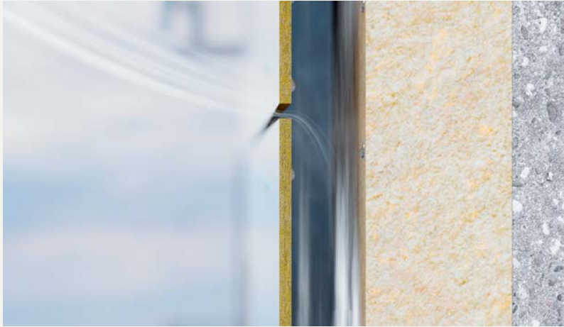
Ventilationseffekten bagved og gennem samlingerne i facadebeklædningen
